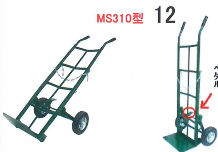
全長1550、全幅600、車輪径250mm自重25kg サイズや種類の違うボンベを運搬する事が出来ペダルを踏むと車体が斜めになりより運搬しやすくなっています。
